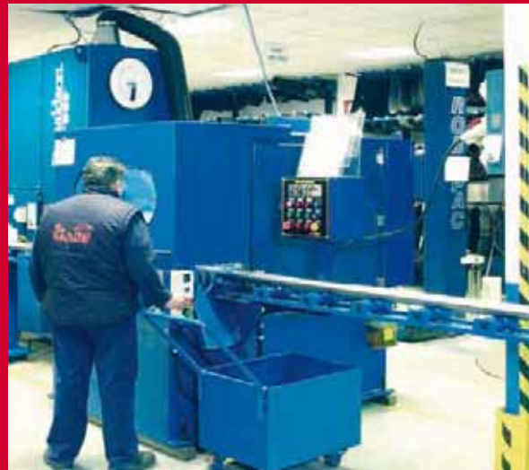
Tronzado y rectificado de ejes y guías
