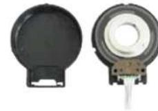
Las series HKY56 son dos o tres encoders ópticos incrementales de alto rendimiento. Estos encoders acentúan la alta fiabilidad, la alta resolución y el fácil montaje. Cada codificador contiene un LED (emisor), un circuito con detectores integrados y un circuito de salida. Una rueda de código que gira entre el circuito integrado del detector y el emisor.
